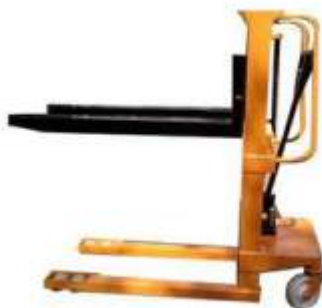
DE - 114 Mini Hydraulic Stacker Capacity: 1000kgs / 1500kgs
